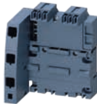
3-Phasen-Sammelschiene mit Einspeisung links inkl. Abdeckung für zwei Leistungsschalter (Schraub- oder Federzugtechnik) 3RV2917-1A
