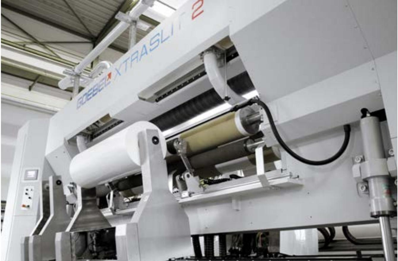
Die GOEBEL XTRASLIT 2 ist eine innovative Rollenschneidmaschine und setzt Maßstäbe in der hochproduktiven Verarbeitung von Papier, Folien und flexiblen Verpackungsmaterialien.
