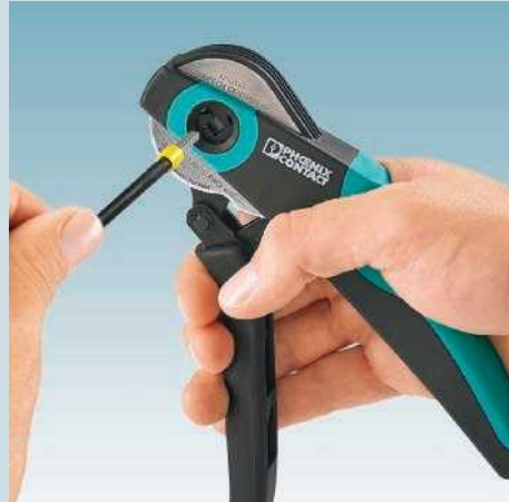
Die CRIMPFOX CENTRUS crimpt isolierte, unisolierte und Twin-Aderendhülsen in einem Querschnittsbereich von 0,14–6 mm 2 bzw. 0,14–10 mm 2 .
